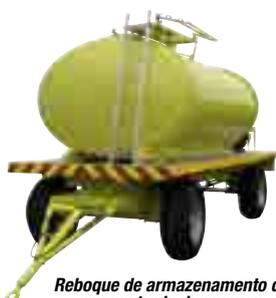
*Reboque de armazenamento de concentrado de espuma*
