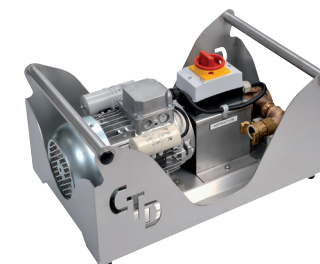
40 l/min bomba elétrica de transferência portátil
